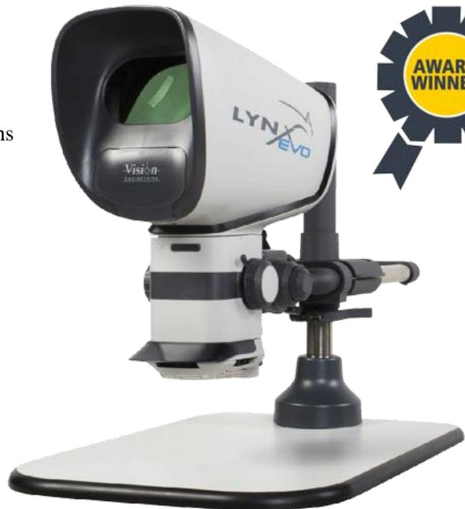
Avec le dispositif optique sans oculaire unique et breveté du Lynx EVO, les opérateurs n'ont plus à adopter de pratiques de travail contraignantes et cela ouvre la voie à une efficacité accrue grâce à une facilité d'utilisation et des performances ergonomiques sans pareil. Il a été honoré avec le Prix de l'innovation 2016 Microscopy Today.
